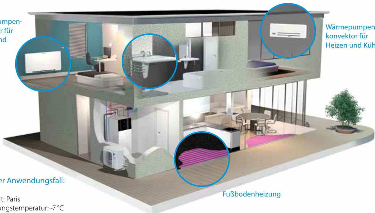
Wärmepumpenkonvektor für Heizen und Kühlen
